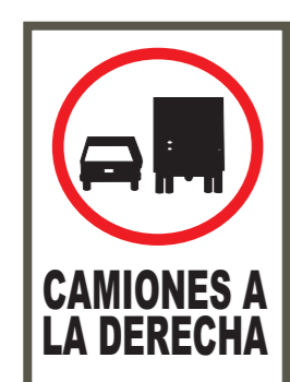
R-18 TRANSITO PESADO CARRIL DERECHO
