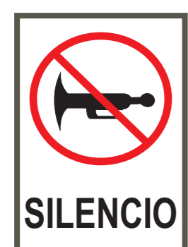
R-29 PROHIBIDO EL USO DE LA BOCINA
