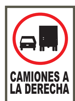
R-18 TRANSITO PESADO CARRIL DERECHO
