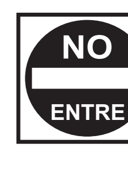
R-38 PROHIBICIÓN DE INGRESO
