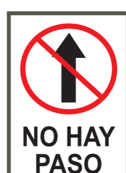
R-4 PROHIBIDO SEGUIR DE FRENTE
