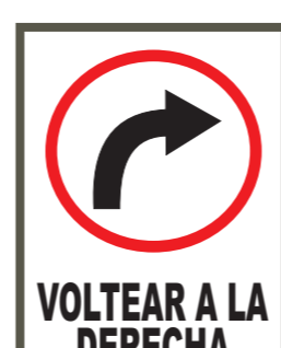
R-7 GIRO SOLAMENTE A LA DERECHA
